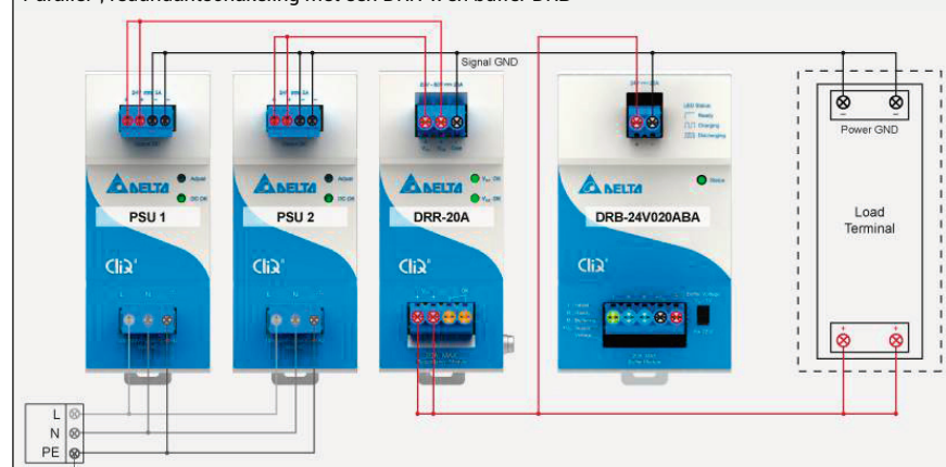
Parallel-, redundantschakeling met een DRR-x en buffer DRB
